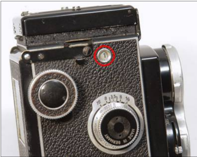
Figure 9 : compteur de vues d'unRolleicord arrêté sur la photo 1
