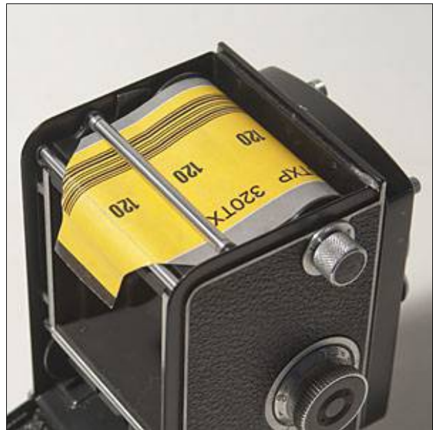
Figure 11 : Rolleiflex automat, le papier protecteur du film est engagé sous le rouleau palpeur
