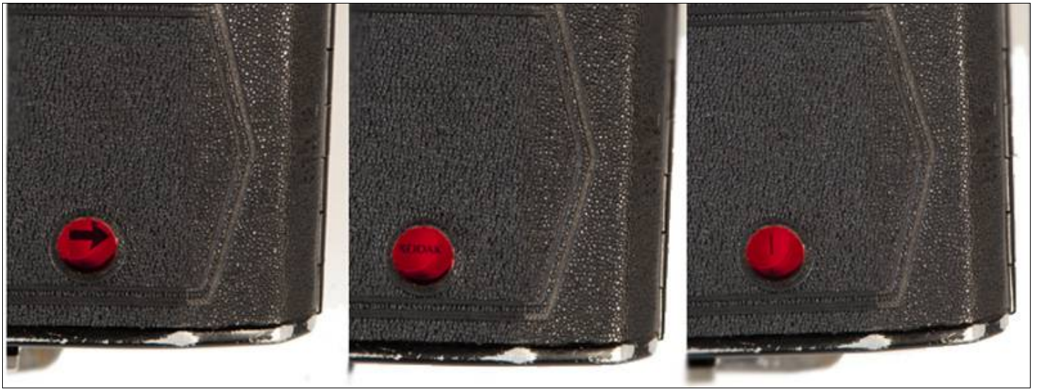
Figure 7 : ce que l'on voit dans le regard inactinique: d'abord des flèches, puis pour chaque vue un texte (marque) et le numéro
